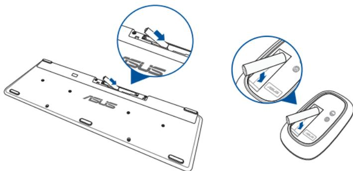
2. Collegate il dongle wireless per tastiera e mouse alle porte USB 2.0 in modo da accoppiare automaticamente entrambi i dispositivi al vostro ASUS All-in-One PC.
