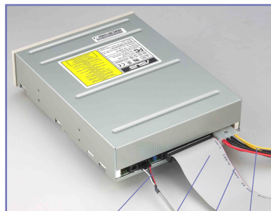
CD-ROM 音源線 IDE 排線 紅色端為第一腳位 電源線 (P4)
