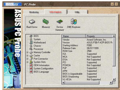
DMI Explorer CPUの種類・内部/外部クロック周波数、メモリ容量など、コンピュータに関する情報を表示します。
