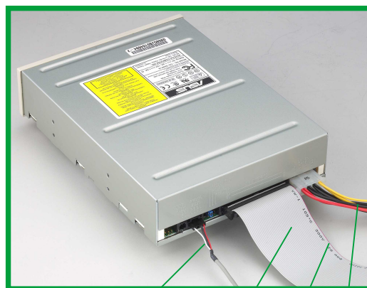
CD/DVD-ROM オーディオケーブル IDEフラットケーブル 1番ピン(赤) 電源ケーブル(P4)
