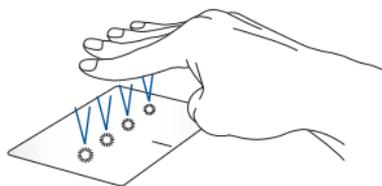
Appuyez rapidement sur le pavé tactile avec quatre doigts pour ouvrir le centre d'action.
