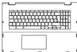
**Clavier (module supérieur du châssis)**
