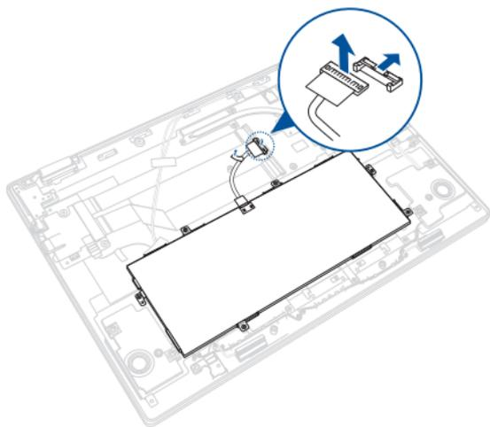
Pour connecter la batterie, alignez et connectez le câble au connecteur pour batterie avant de replacer le couvercle du compartiment.
