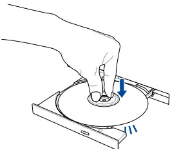
5. 將托盤輕輕推回光碟機中。
