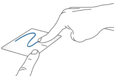
Odaberite stavku i zatim pritisnite i držite lijevu tipku. Drugi prst povlačite po dodirnoj plohi i pomičite stavku, dignite prst i odvojite ga od gumba radi spuštanja stavke.
