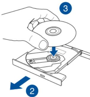
4. 将光盘中央的塑胶圈环轻轻向下压直到与光驱托盘完全接合。
