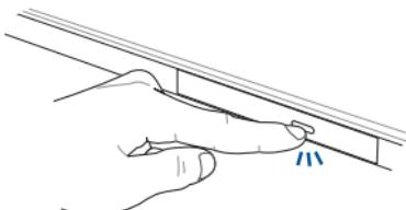
2. 请将光驱托盘完全拉出。
