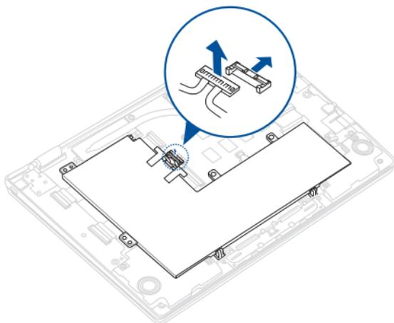
Pour connecter la batterie, alignez et connectez le câble au connecteur pour batterie avant de replacer le couvercle du compartiment.
