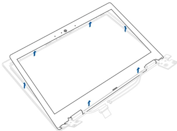
G. Retirez la/les vis de l'écran LCD. Ne retirez pas encore l'écran LCD !
