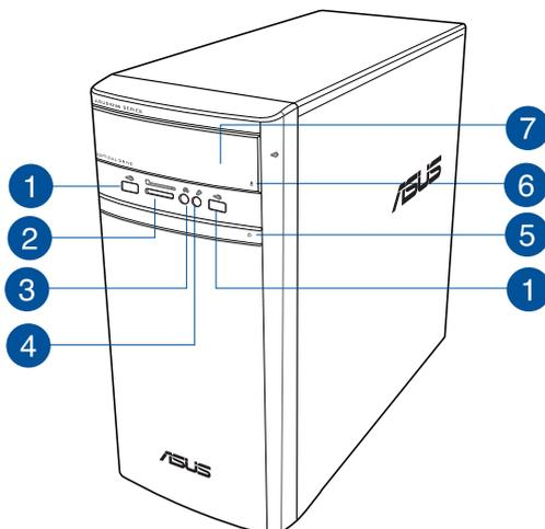
**1 Ports USB 3.0.** Ces ports USB (Universal Serial Bus) 3.0 permettent de connecter des périphériques disposant de ports USB 3.0 (souris, imprimante, PDA, appareil photo).
