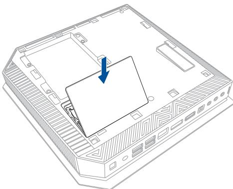
11. サイドカバーをフロントパネルの方向にスライドし、ケースに取り付けます。
