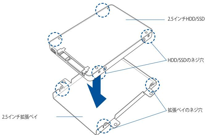
10. 同梱のネジを使用し、拡張ベイに2.5インチHDD/SSDを固定します。
