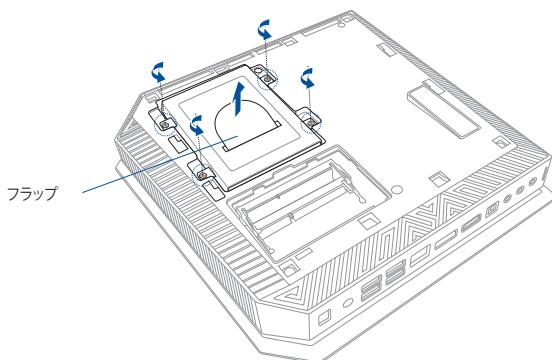
8. 2.5インチHDD/SSDと同梱のネジ4本を手元に用意します。
