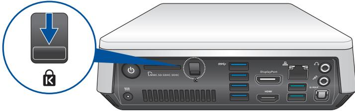
5. トップカバーをバックパネルの方向にスライドし、ケースから取り外します。
