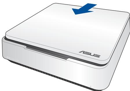
15. ラッチをロックし、トップカバーをケースに固定します。
