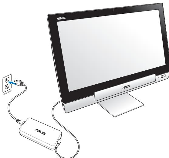
1. Connectez une extrémité de l'adaptateur secteur à la prise d'alimentation de la station PC, et l'autre extrémité à une prise électrique en faisant attention à ce que celle-ci dispose de la bonne tension. La tension d'entrée de l'adaptateur secteur est de 100Vca~240Vca.
