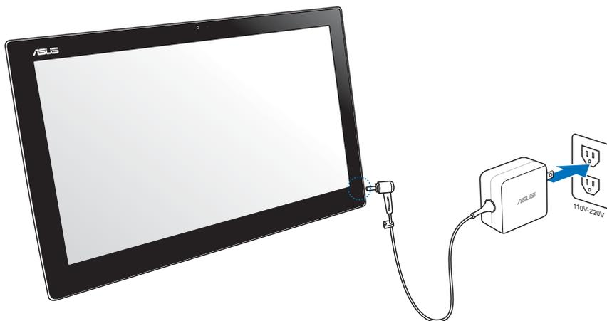
ACアダプターをASUSタブレットのDC入力ポートに接続し、電源コンセントに接続します。ACアダプターの入力電圧は100Vac～240Vacです。
