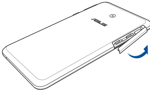
3. 按壓想要移除的 micro-SIM 卡，並將 micro-SIM 卡由插槽中取出。
