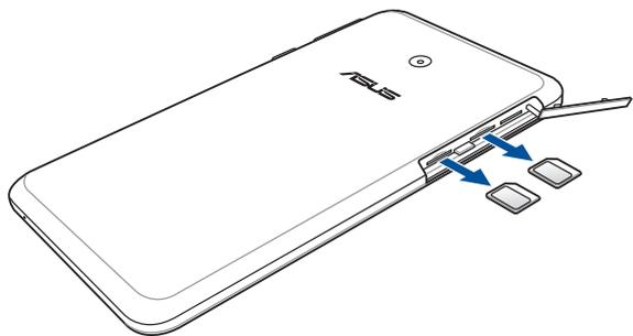
5. 將 micro-SIM 卡至插槽內取出後，請確保側蓋已完全蓋上。
