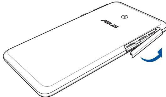
2. 如下圖所示的方向，將 microSD 記憶卡的金色接腳朝上，與平板電腦平行，緩緩推入插槽內。
