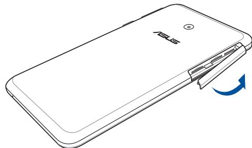
3. 如下圖所示的方向，將 micro-SIM 卡的金色接腳朝上，與平板電腦平行，緩緩推入 SIM 1 插槽內。
