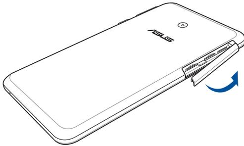
3. 如下圖所示的方向，將 micro-SIM 卡的金色接腳朝上，與平板電腦平行，緩緩推入 SIM 1 插槽內。
