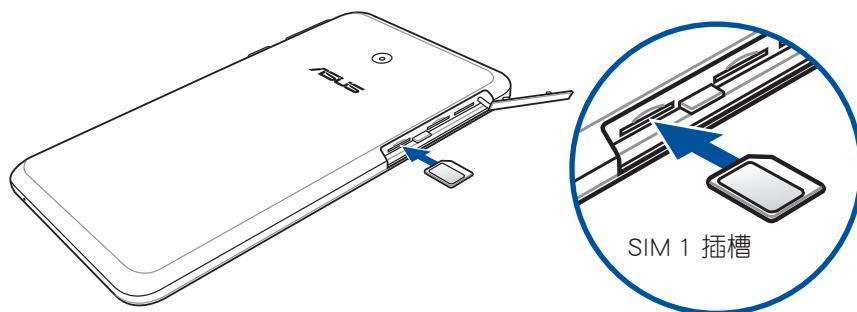
5. 您最多可以安裝 2 張 micro-SIM 卡至 micro-SIM 卡插槽。若您需安裝另一張 micro-SIM 卡，如下圖所示的方向，將 micro-SIM 卡的金色接腳朝上，與平板電腦平行，緩緩推入 SIM 2 插槽內。
