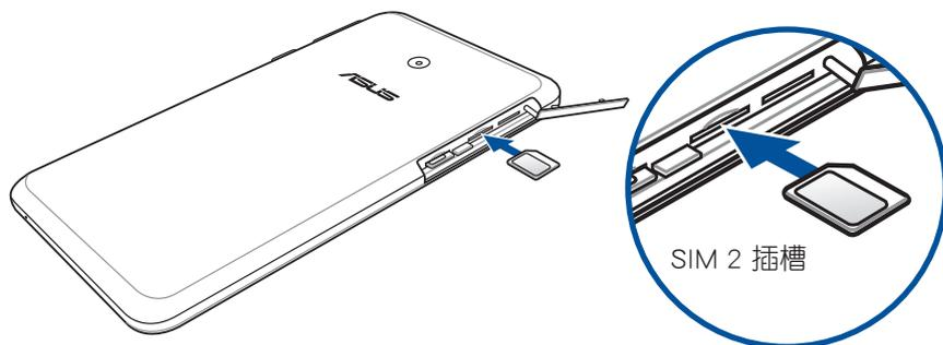
7. 將 micro-SIM 卡安裝至插槽內後，請確保側蓋已完全蓋上。
