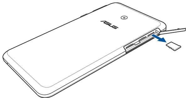
3. 將 microSD 記憶卡至插槽內取出後，請確保側蓋已完全蓋上。
