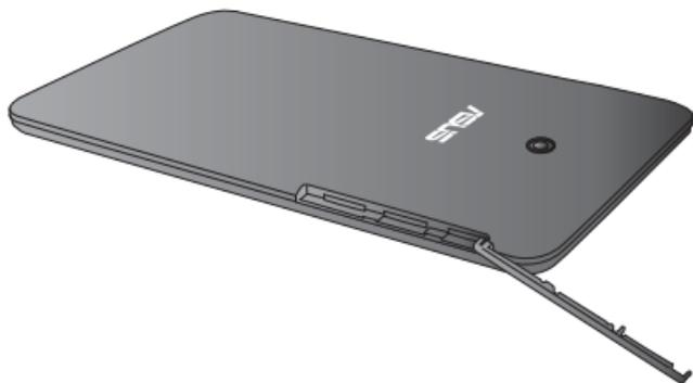
2. Inserite una microSD nello slot microSD assicurandovi che i contatti metallici siano rivolti verso l'alto, come mostrato nella figura seguente.
