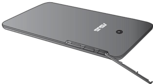
2. Inserite la Micro-SIM nell'alloggiamento Micro-SIM assicurandovi che i contatti metallici siano rivolti verso l'alto, come mostrato nella figura seguente.
