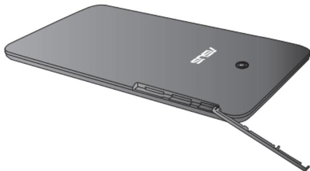
2. Masukkan kartu SIM mikro ke salah satu slot kartu SIM mikro dengan bidang kontak logam menghadap ke atas.
