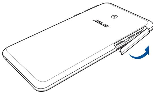
2. 如下圖所示的方向，將 microSD 記憶卡的金色接腳朝上，與平板電腦平行，緩緩推入插槽內。
