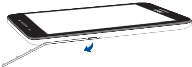
2. Inserite una microSD nello slot microSD assicurandovi che i contatti metallici siano rivolti verso l'alto, come mostrato nella figura seguente.
