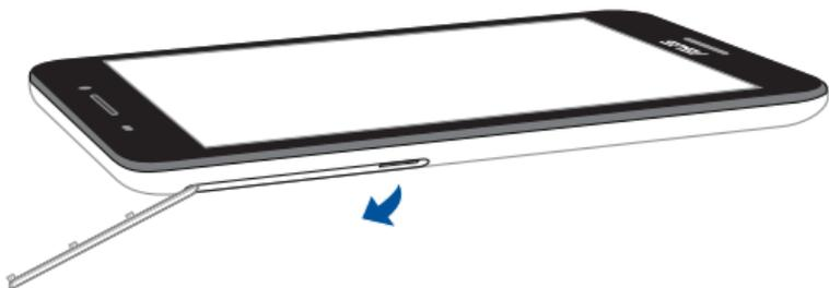
2. Inserite la Micro-SIM nell'alloggiamento Micro-SIM assicurandovi che i contatti metallici siano rivolti verso l'alto, come mostrato nella figura seguente.
