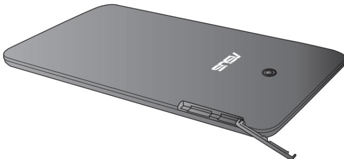
2. Setzen Sie die microSD-Karte in den microSD-Kartenschlitz, wobei die Metallkontakte wie abgebildet nach oben zeigen.
