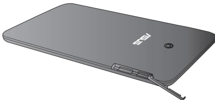
2. Setzen Sie die microSIM-Karte in einen der microSIM-Kartenschlitze, wobei die Metallkontakte wie abgebildet nach oben zeigen.
