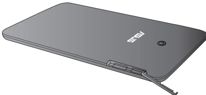
2. Inserte la tarjeta micro-SIM en cualquiera de las ranuras para tarjetas micro-SIM con los contactos metálicos orientados hacia arriba.
