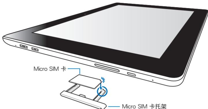
C. 请将 micro SIM 卡托架推入至插槽内。
