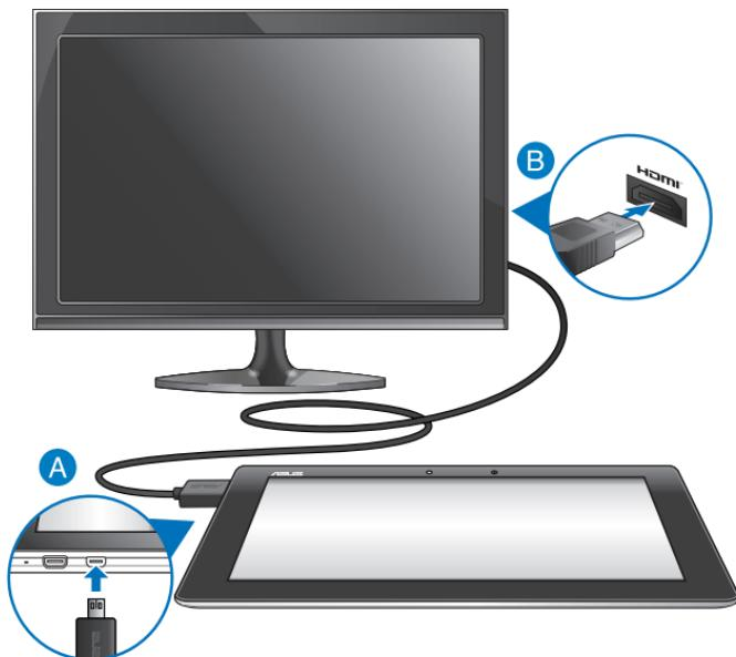
请依照以下步骤将平板电脑连接兼容 HDMI 的外接显示设备：
