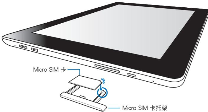
C. 请将 micro SIM 卡托架推入至插槽内。
