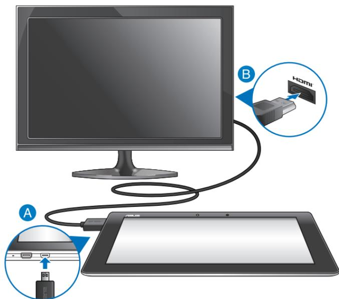
请依照以下步骤将平板电脑连接兼容 HDMI 的外接显示设备：
