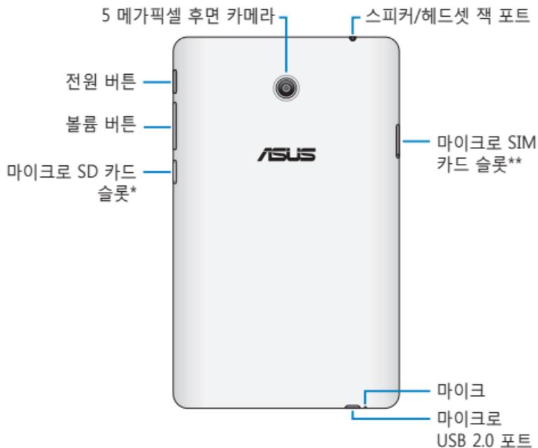
\* microSD 카드 슬롯은 microSD, microSDHC 및 microSDXC 카드 포맷을 지원합니다.
