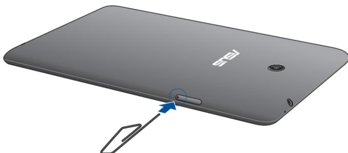
2. Retire a bandeja do cartão micro SIM e coloque o cartão micro SIM na bandeja com os contatos de metal virados para cima, como mostrado.
