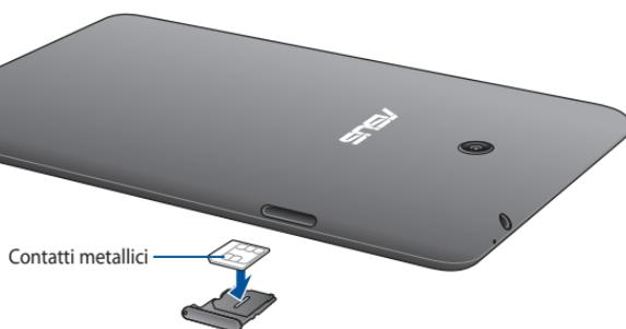
3. Allineate ed inserite il vassoio della Micro-SIM all'interno del suo alloggiamento.
