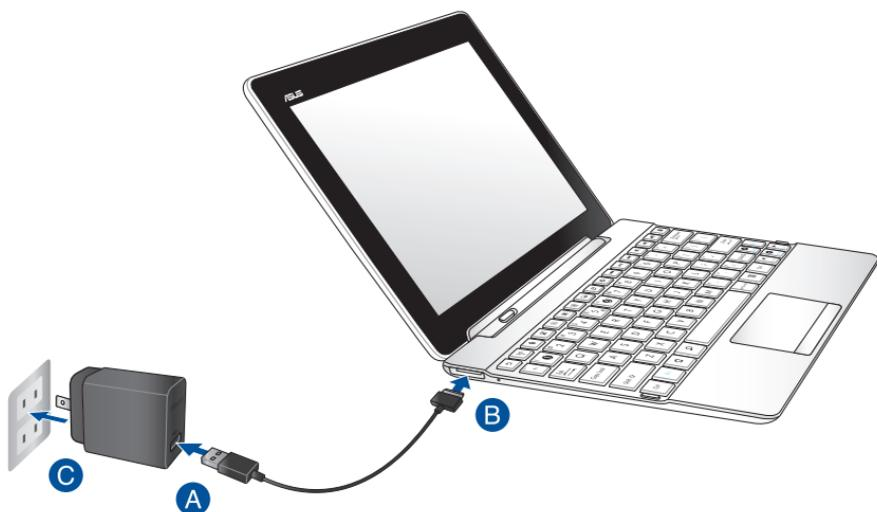
Per ricaricare la batteria del tablet ASUS quando il tablet è collegato alla mobile dock:
