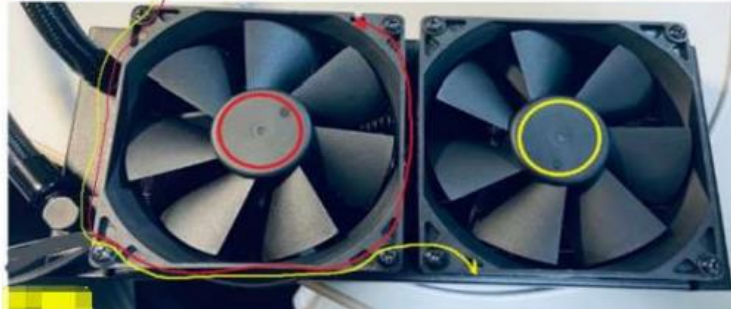
圖二、系統風扇線穿線圖示 (穿在螺絲內側) Cables inside the screws
