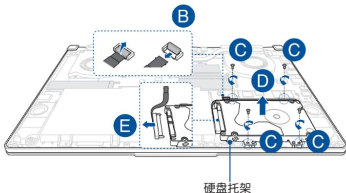
F. (选配) 若硬盘与硬盘托架连接, 请参考下列步骤移除旧硬盘:
