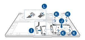
**NOTA:** O cabo flexível do circuito impresso está dobrado numa forma particular. NÃO tente alterar a forma original ou pressionar excessivamente a linha de dobra.
