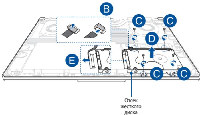
F. (дополнительно) Если жесткий диск установлен в корзину, извлеките его, следуя инструкциям ниже:
