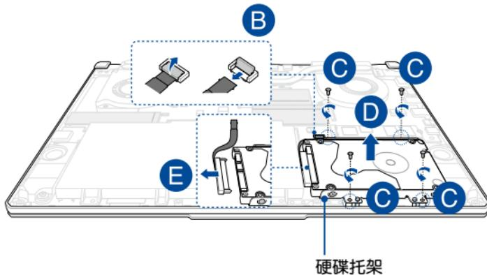
F. 若硬碟安裝於硬碟托架中，請參考下列步驟取下舊硬碟：
