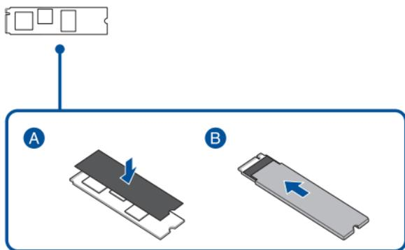
3. Alinee e inserte los módulos SSD M.2 en los conectores M.2 y fije los módulos SSD M.2 a la placa base con los tornillos que retiró anteriormente.
