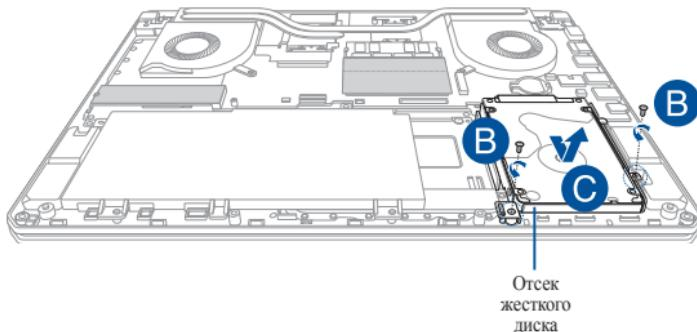
D. (дополнительно) Если жесткий диск установлен в корзину, извлеките его, следуя инструкциям ниже:
