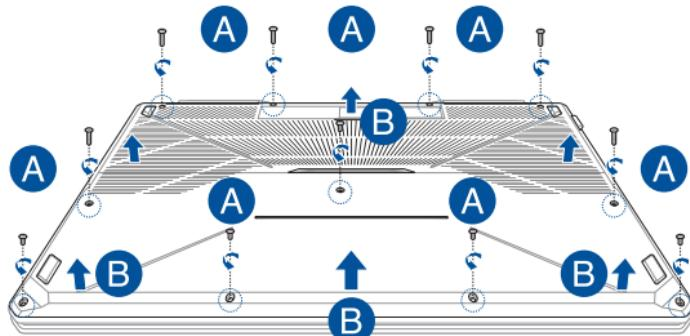
Для закрытия крышки отсека:
