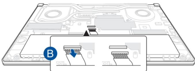
Pour connecter la batterie, alignez et connectez le câble au connecteur pour batterie avant de replacer le couvercle du compartiment.
