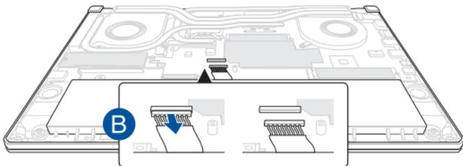
배터리를 연결하려면, 컴파트먼트 커버를 다시 부착하기 전에 케이블을 배터리 커넥터에 정렬하고 연결하십시오.
