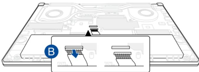
要連接電池，請在重新安裝擴充插槽護蓋之前，將傳輸線對準並連接至電池連接埠。
