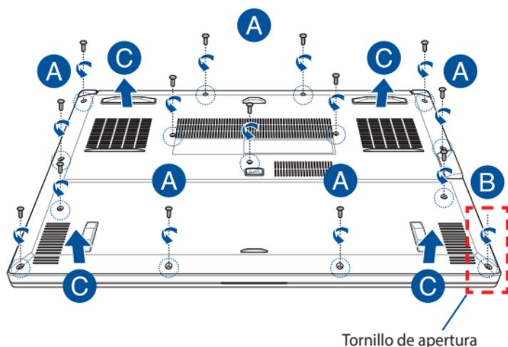
Para volver a acoplar la tapa del compartimento:
