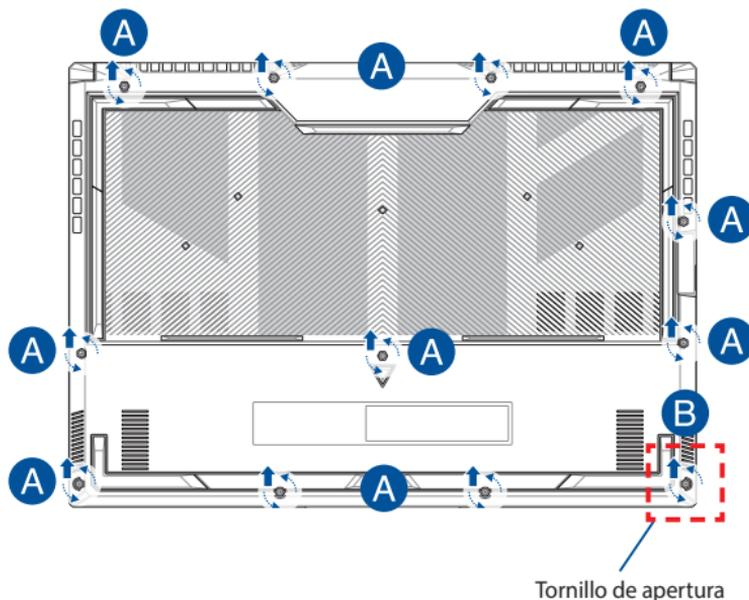
Para volver a acoplar la tapa del compartimento:
