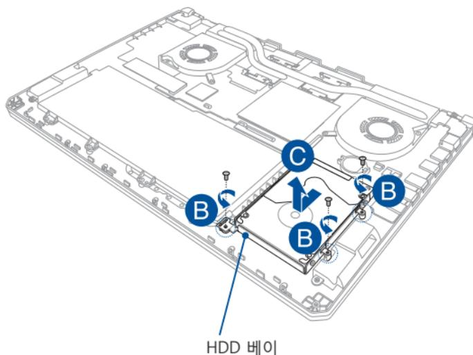
D. (옵션) HDD 베이에 현재 HDD가 연결되어 있으면, 기존 HDD를 제거하는 다음 단계를 참조하십시오.
