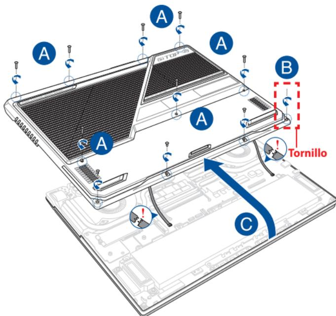
Para volver a acoplar la tapa del compartimento:
