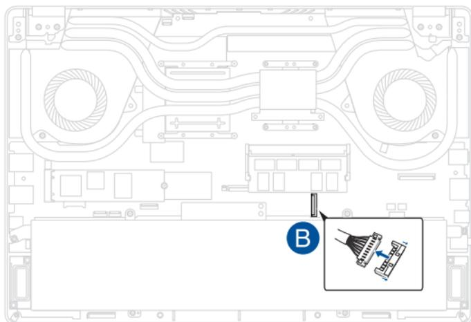
Pour connecter la batterie, alignez et connectez le câble au connecteur pour batterie avant de replacer le couvercle du compartiment.
