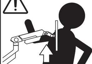
モニターアームが最も高い位置にあるときを除き、取り付けられた機器をモニターアームから取り外さないでください。アーム機構には張力が作用しており、機器を取り外すとモニターアームが素早く上に跳ね上がることがあります。この警告に従わなかった場合、死亡を含む傷害や事故、製品の破損が生じるおそれがあります。
