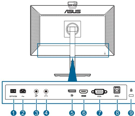
1. **Ein-/Aus-Schalter.** Zum Ein-/Aus-schalten der Stromversorgung.
