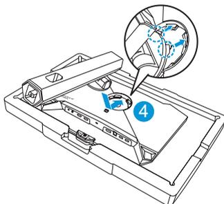
5. Richten Sie die Basis am Ständer aus und installieren Sie sie.
