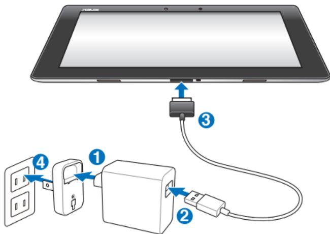
**ATTENTION :** vérifiez soigneusement les connexions et assurez-vous que la fiche d'alimentation soit correctement branchée au chargeur pour éviter la surchauffe et d'endommager les câbles, le chargeur ou l'appareil.
