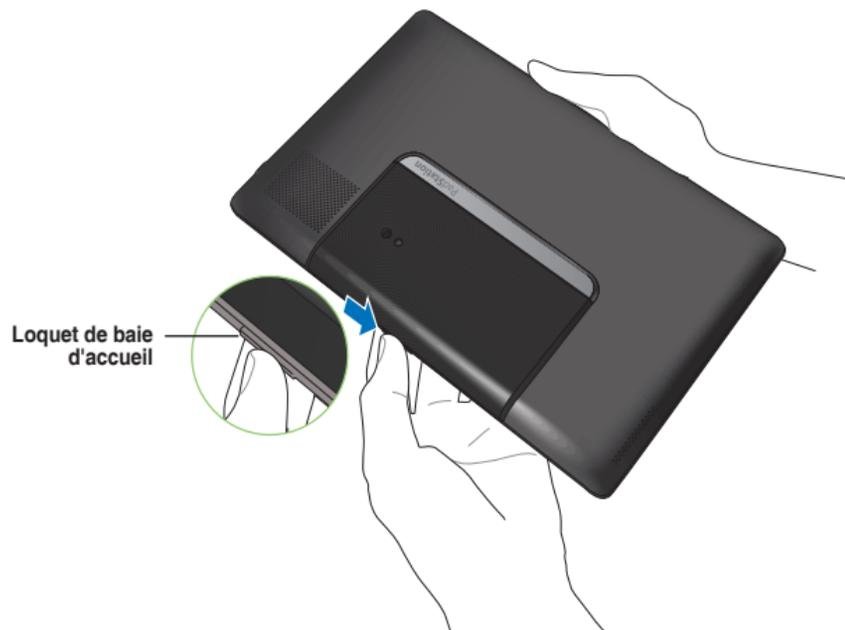
2. Poussez la trappe de la baie d'accueil jusqu'à un angle de quatre-vingt dix degrés (90°) pour que le PadFone se sépare complètement des connecteurs.
