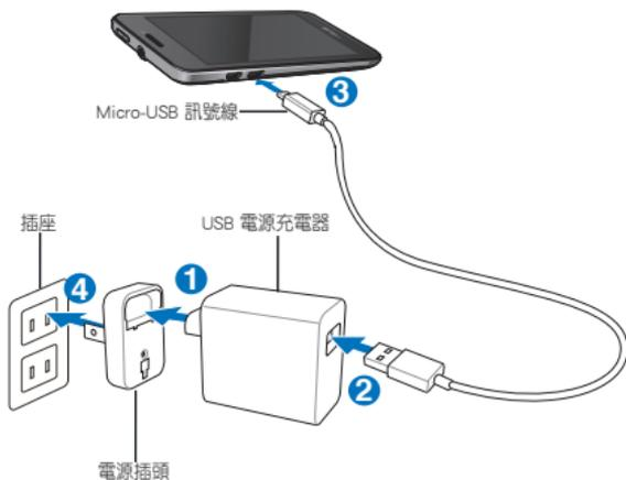
**注意！**請再次確認電源插頭與電源充電器已連接妥當，避免因過熱而造成訊號線、充電器或裝置損壞。
