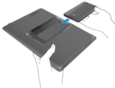
2. Insérez complètement votre PadFone Infinity dans la baie jusqu'à ce qu'il soit correctement connecté à la PadFone Infinity Station. Le PadFone Infinity vibre brièvement lorsque la connexion est sécurisée.
