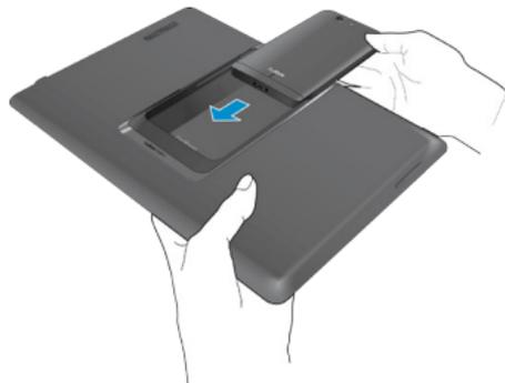
Après avoir correctement inséré votre PadFone Infinity dans la tablette PadFone Infinity Station, Android ajuste automatiquement l'écran et les applications pour travailler en format tablette.
