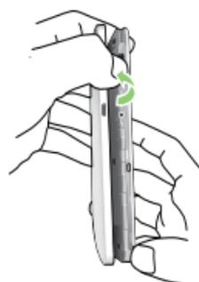
4. Alignez les boutons latéraux du PadFone mini avec le couvercle et sécurisez ce dernier en place.
