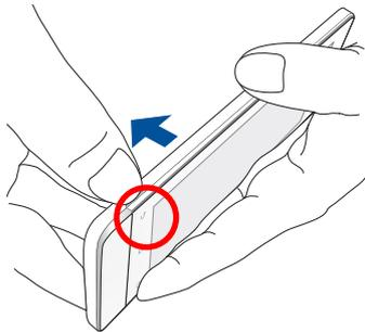
2. Richten Sie die Speicherkarte am Speicherkartenschlitz aus und stecken sie ein.
