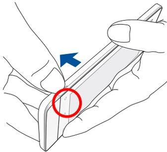
2. Bringen Sie die Rückabdeckung wieder an. Drücken Sie die Rückabdeckung an allen Seiten zum Befestigen nach unten.
