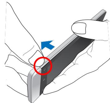
2. Bringen Sie die Rückabdeckung wieder an. Drücken Sie die Rückabdeckung an allen Seiten zum Befestigen nach unten.
